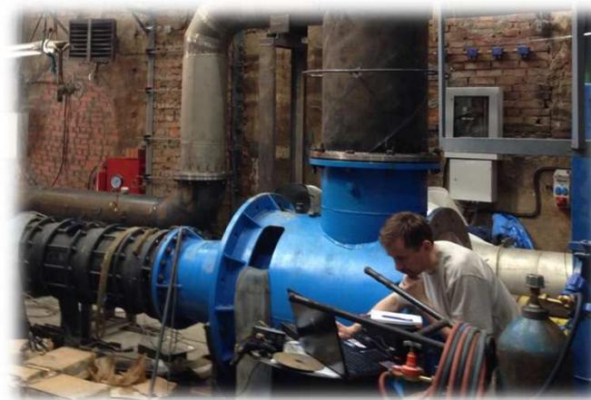
Проведены испытания головного образца агрегата электронасосного 60ДСВ-0,9/48, изготовленного ПО «СВЕРДМАШ» (2016 г.)
