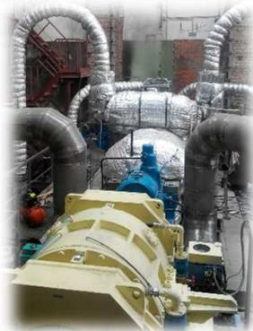
Проведены испытания двух гидравлических динамометров фирмы «Fuchino» СFT-9,0 на мощности до 12 МВт. Разработана эксплуатационная документация на гидравлические динамометры по результатам испытаний (2016 г.)
