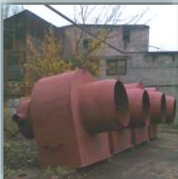
Горелка газомазутная ГМУ-м с трубчатой раздачей газа
