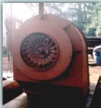
Горелка газомазутная ГМУ-м с трубчатой раздачей газа
