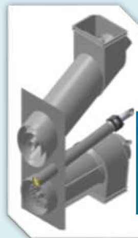
Горелка газовая для сжигания доменного и природного газов
