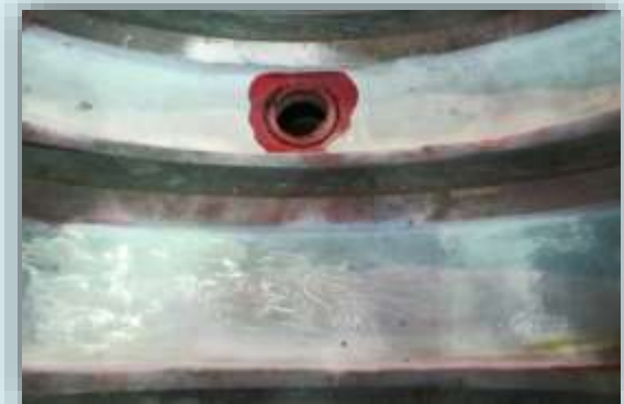
Сквозные трещины в литых корпусах ЦВД до и после заварки
