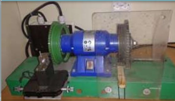
1. Стенд для тарировки датчиков АСДЛ «СКАЛА»
