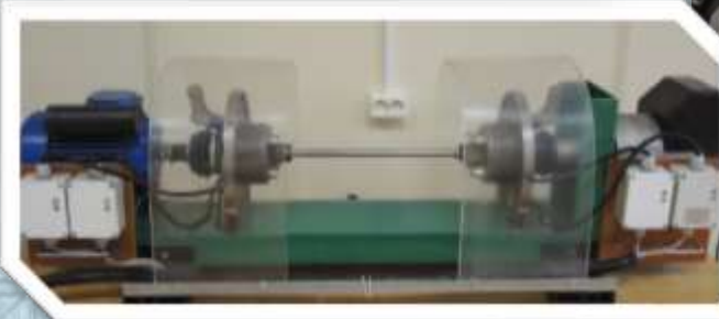
7. Стенд, моделирующий закрутку валопровода
