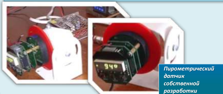
Схема установки датчиков для измерения величины закрутки вала
