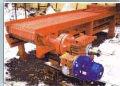
Топка ВТКС тепловой мощностью 7,56 МВт
