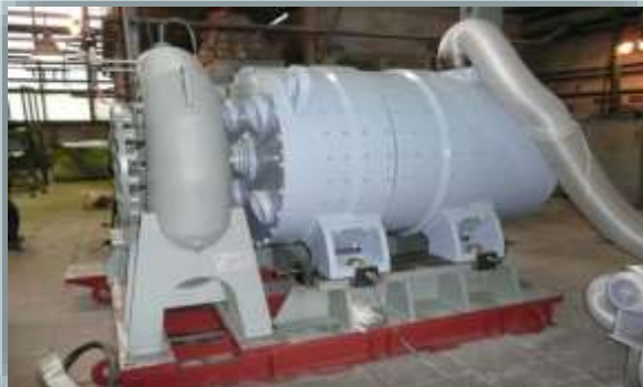
Гидроагрегат мощностью 1,8 МВт Джрадзор ГЭС (Армения)
