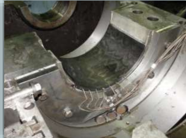
Монтаж опорного подшипника скольжения с новым синтетическим материалом рабочей поверхности перед проведением испытаний
