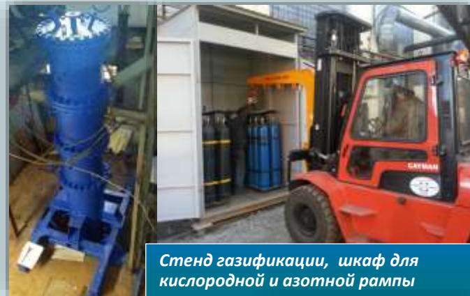
Камера сгорания предназначенная для растопки котла работающего с кипящим слоем
