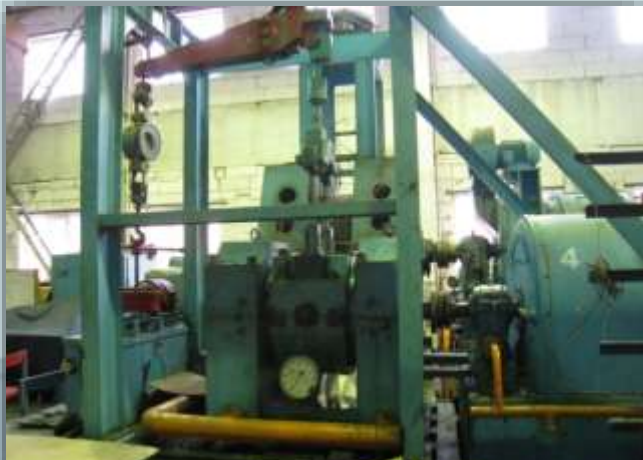
Стенд исследований опорных подшипников скольжения диаметром до 450 мм
