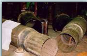
жаровые трубы растопочных камер на дизельном топливе
