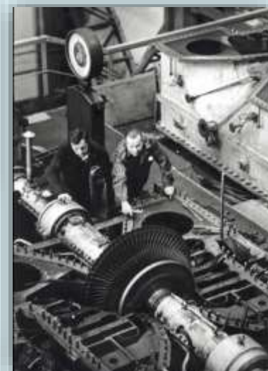
1985 г. Сотрудники лаборатории аэродинамики паровых турбин подготавливают модель турбины ЭТНД-2 к стендовым испытаниям
