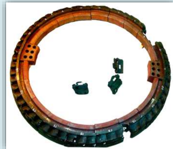
Выкладка поврежденных сварных пакетов лопаток регулирующей ступени после разлопачивания
