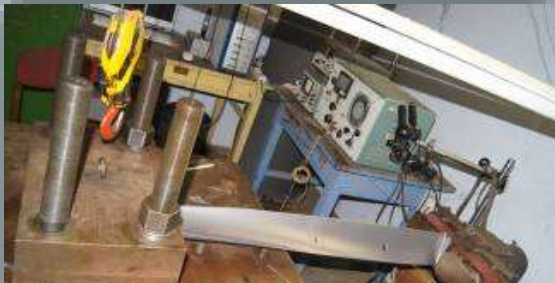
4. Стенд для проведения усталостных испытаний (вибротумба)
