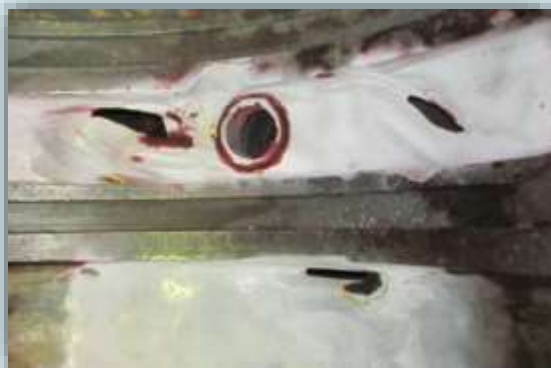
Сквозные трещины в литых корпусах ЦВД до и после заварки
