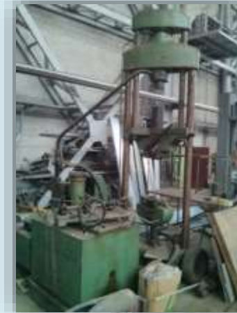
Разрывная машина МУП -100 Максимальное усилие - 100т
