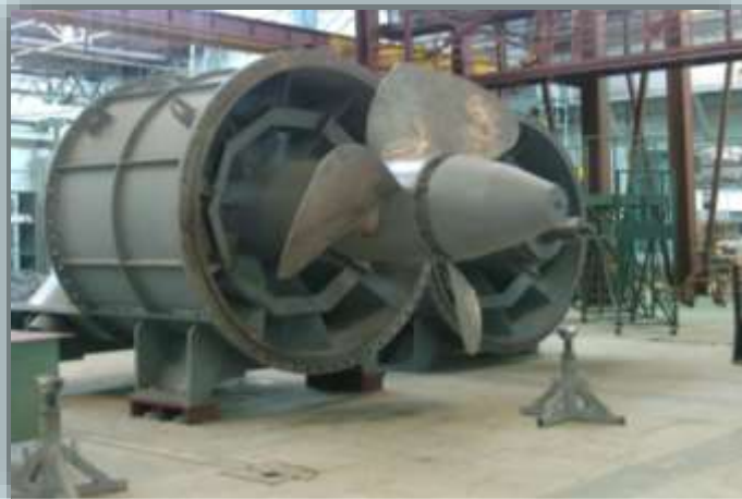
Агрегат Миту ГЭС (Колумбия) с переменной частотой вращения
